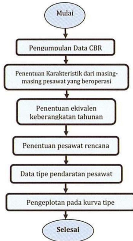
Gambar 1. Diagram Alir Perencanaan Perkerasan Lentur
